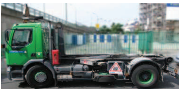
Un porteur de la régie pour le transport de caissons (crédits DPE)
